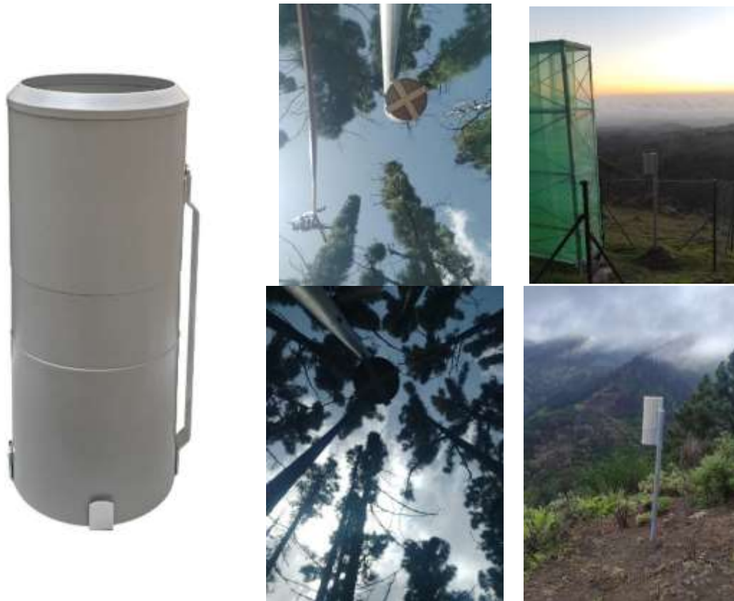
Figura 20: Pluviómetro Hellmann (izq.) y pluviómetros instalados bajo cubierta y fuera de cubierta en las zonas de estudio
