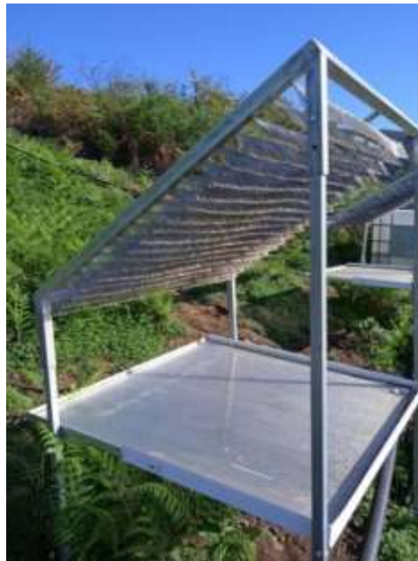
Figura 22: Captadores de niebla del modelo tradicional.
