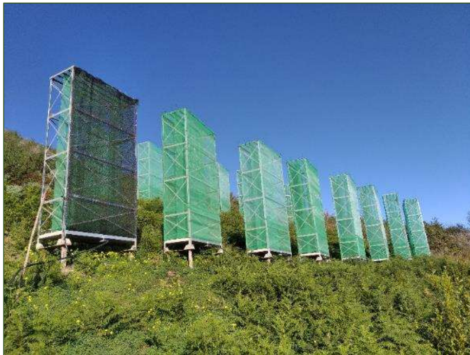
Figura 31. Captadores de niebla tipo RAA
