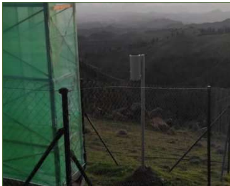
Figura 33. Pluviómetro colocado al lado de captadores de niebla
