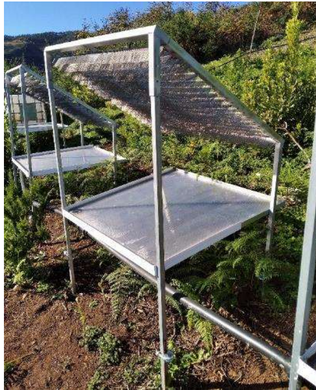
Figura 32. Captador de niebla tipo mesa
